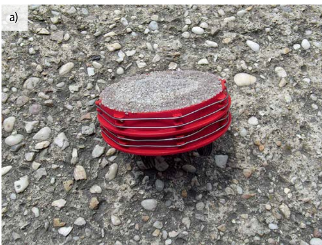
Abb. 8 a+b: Korrosions- und Feuchtesensor BS2 (Quelle: BS2 Sicherheitssysteme GmbH)
